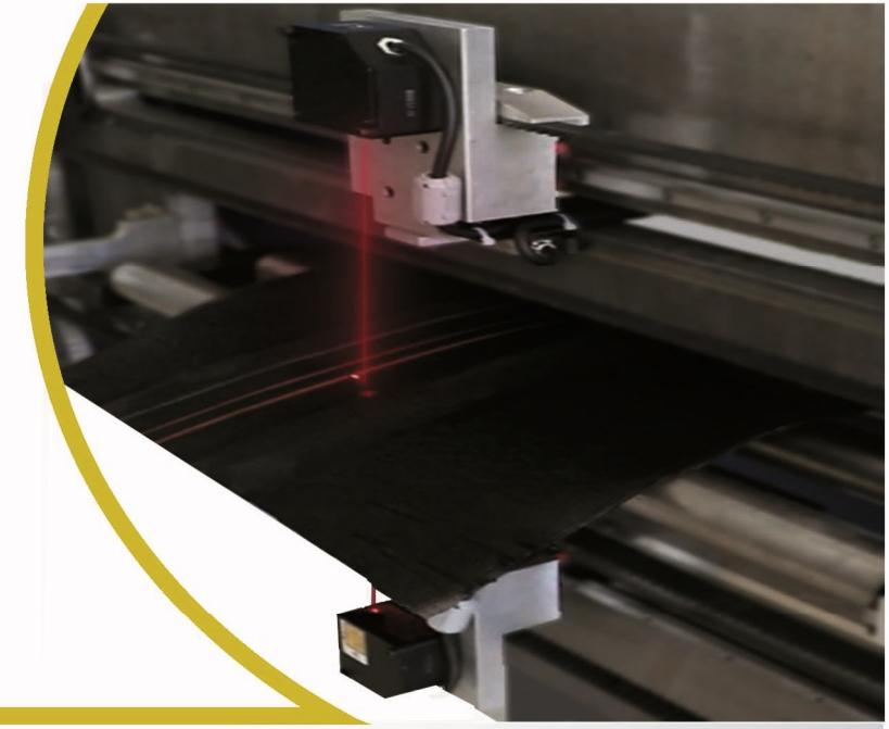
✓ سیستم اندازه گیری ضخامت، ثابت و عمود بر خط تولید بوده و ضخامت
